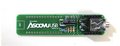
二本のピンソケットを挿し、同梱されている [Si4735 ラジオモジュール] を載せて半田付けを行うと、真っ直ぐに付け易くなります。
