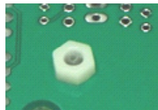
三端子レギュレータを固定したときの基板裏側
