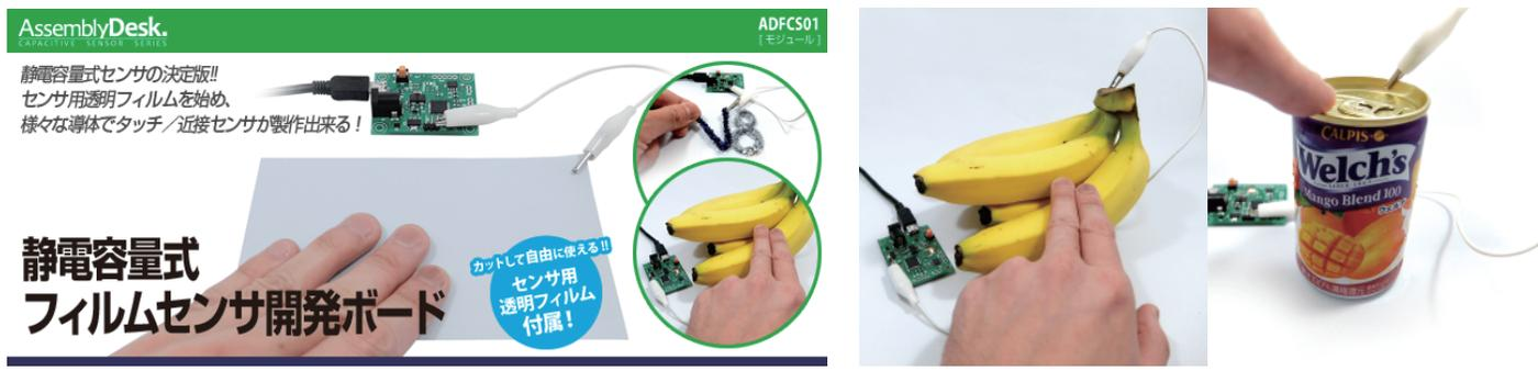
静電容量の変化で近づくだけで反応する近接センサや、触るだけで反応するタッチセンサなど様々な形態のセンサを検証・構築が可能なセンサ開発ボードです。付属の透明フィルムを始め、銅テープ、バナナなどアイデア次第で様々な導体を近接センサとして利用することができ、モニタツールを用いて画面上で静電容量の変化を見ながら感度やしきい値などの調整を行うことができます。
