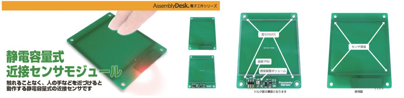
触れることなく、人の手などを近づけると動作する、静電容量式の近接センサです。タッチセンサと異なり、触れる必要はありません。モジュール形式となっていますので手軽に近接センサの動作を試すことができます。
