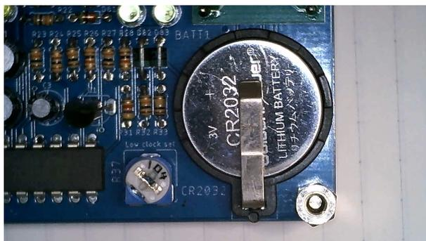
図 9: バックアップ電池
