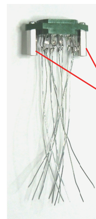
ニキシー管ソケットにスズメッキ線をハンダ付け (スズメッキ線の長さは 10cm)
