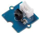
図1 赤外線レーザーの「Grove - Infrared Receiver」
